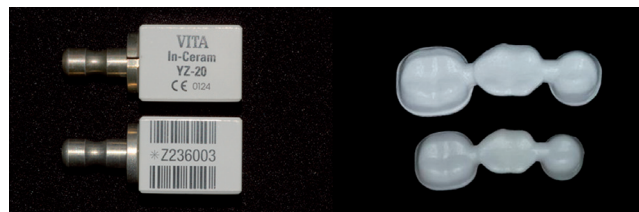
Figura 3A. Blocos de YZ Ceram (Vita) parcialmente sinterizados, com código de barras para identificação da densidade e encolhimento esperado; 3B. prótese parcial fixa usinada ~25% aumentada e encolhida até o tamanho desejado após sinterização final
