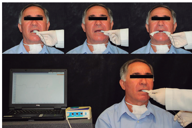
Figura 1. Foto ilustrativa dos diferentes posicionamentos da célula de carga durante as mordidas entre incisivos e molares (acima); aquisição dos valores (em Kgf) de força de mordida (abaixo)
