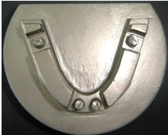
Figura 1. Modelo mestre em aço inoxidável com marcações em "X" utilizado no presente trabalho
