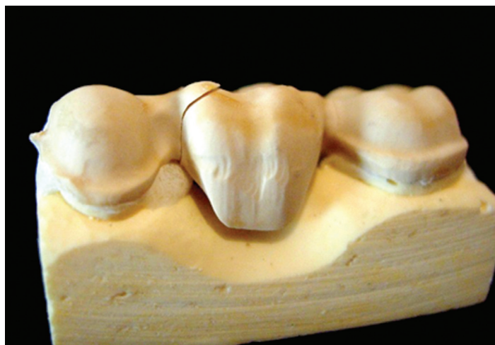
Figura 1. Modo de fratura mais comumente encontrado em uma PPF. A fratura se estende da parte gengival do conector até a face oclusal do pântico
