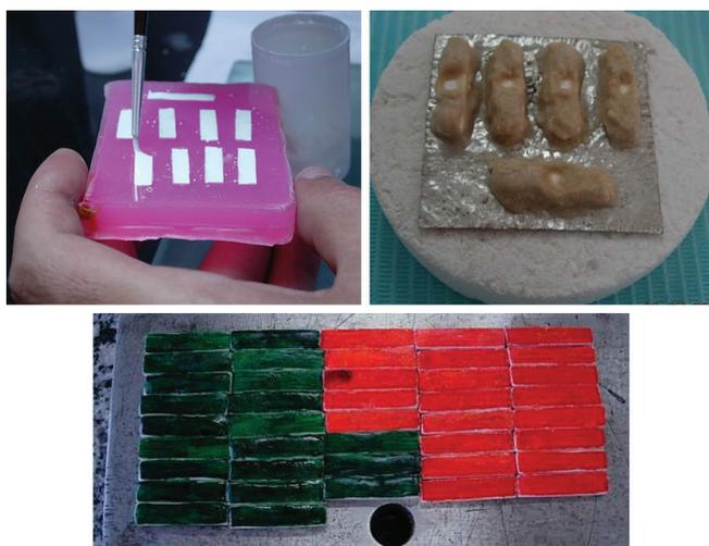
Figura 1. Preparo dos corpos de prova. 1A) Aplicação da barbotina na moldagem de silicone de laboratório; 1B) corpos de prova infiltrados pelo borossilicato de lantânio, sobre placa de platina; 1C) preparo e retífica dos corpos de prova: Alglass- verde, In-Ceram Alumina-vermelho
