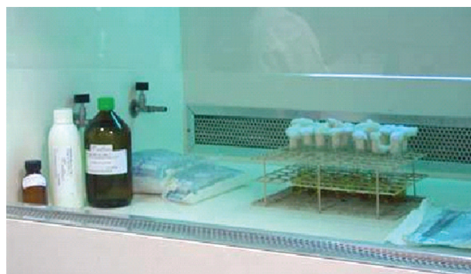
Figura 2. Material para descontaminação (cones, soluções) dentro do fluxo laminar
