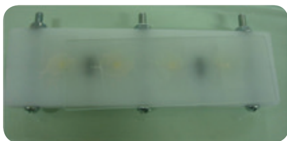
Figura 1. Corpos de prova armazenados na estufa a 37° C por 7 dias
